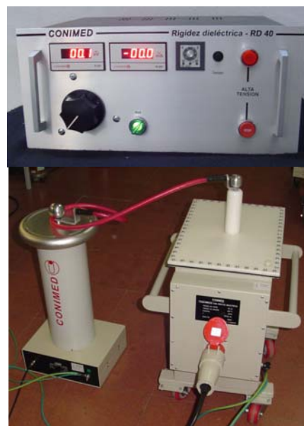
Unidad de Control, Transformador de Alta Tensión y Divisor Resistivo
